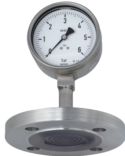
Separator membranowy, przyłącze kołnierzowe model 990.27 z manometrem model 232.50 NS 100, opcjonalnie membrana z tantalu
